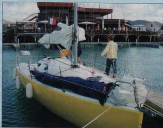
Le sac de la voile d'avant reste à poste comme un lazy-bag.
