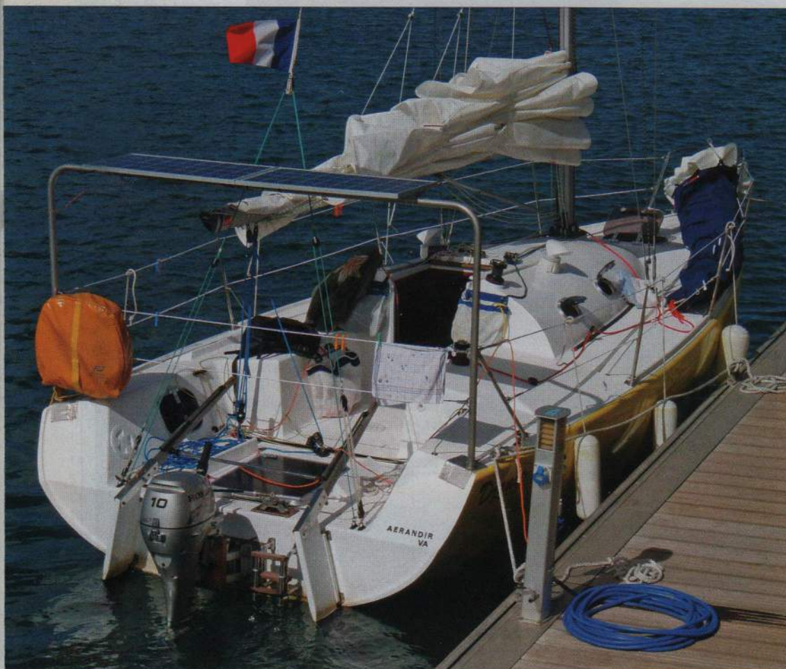
Les panneaux solaires sur le portique et l'alternateur du moteur sont les seules sources d'énergie du bord : c'est insuffisant pour les longues navigations. Le sac dédié à la voile d'avant, en revanche, est une vraie satisfaction.
